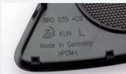
Gravur einer Spritzgußform für Lautsprecherabdeckungen in der Automobilindustrie.
